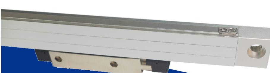
HA400系列绝对值式直线光栅尺可满足最大1240mm的测量长度，并可以Biss-c(32bit/26bit)，SSI协议(27bit)，Fanuc或者松下协议进行位置值传输，该产品最高精度等级为 $\pm 3\mu\text{m}$ ，分辨率最高可达5nm。
