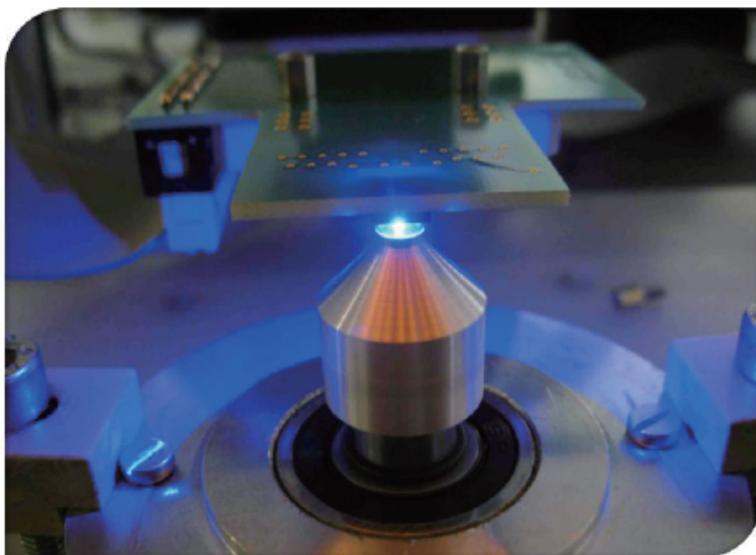
FS36 集成了一个蓝色 LED 用作照明源。该蓝色 LED 具有更高的效率（相同的光功率，工作电流更小），更高的信号清晰度和对比度，更少的输出信号抖动。并由一个闭环控制电路驱动，该电路根据传感器生成的信号的幅度自动调整 LED 电流。这确保了编码器的稳定运行，补偿了由于温度或老化效应导致的 LED 效率偏差之类的变化，补偿了芯片与不锈钢尺带之间的间隙的机械变化。如下图所示：
