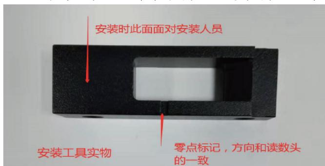
图 1: 安装工具实物图
